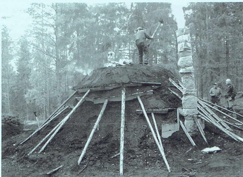
En kamin och en skorsten hjälpte milan Ester med det viktiga draget
